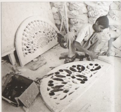
Fig. 15. Artigiano yemenita realizza transenne in stucco completate da pannelli in vetro colorati.
